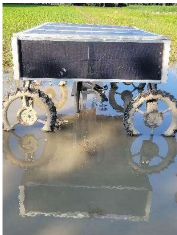
Figure 7. Prototype de robot désherbeur à intelligence artificielle (Wall-Ye) adapté en système rizicole (CFR)
